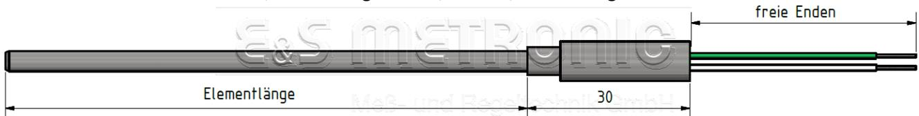
**Bestellbezeichnung z.B.:** 1 x K13,0-300-200-80°C = einfach, NiCr-Ni, Typ K, 2.4816, Ø3,0 mm, Elementlänge 300 mm, 200 mm freie Anschlusslängen, Übergangshülse bis 80 °C Temperatur beständig versiegelt
