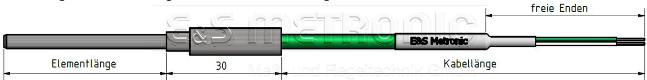
**Bestellbezeichnung z.B.:** 1 x KI1,5-500-1M-2PPL0,22 = einfach, NiCr-Ni, Typ K, 2.4816,  $\varnothing$ 1,5 mm, Elementlänge 500 mm, 1 m Ausgleichsleitung PVC isoliert 2 x 0,22 mm<sup>2</sup>, Übergangshülse bis 80 °C Temperatur beständig versiegelt
