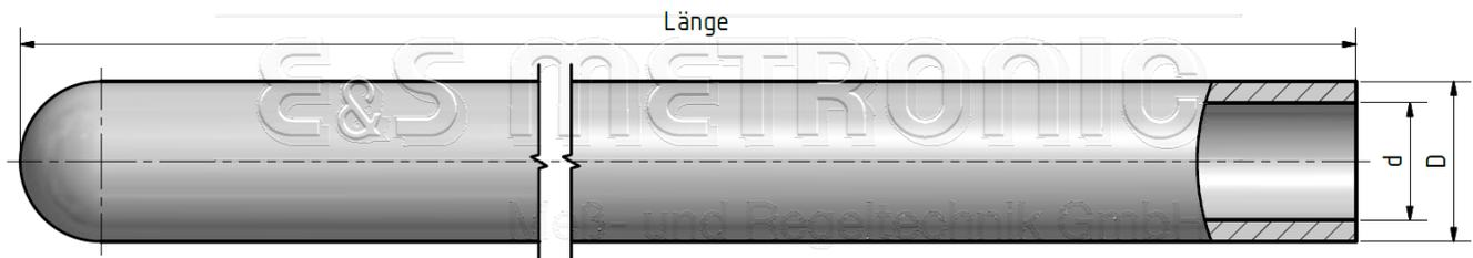
Werkstoff: Keramik Typ C 530 (porös), für Temperaturen bis max. +1.500 °C
