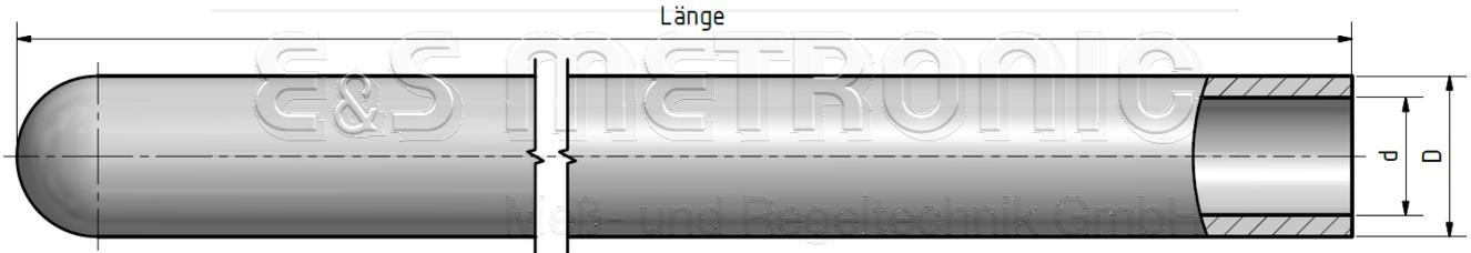
Werkstoff: Keramik Typ C 610, für Temperaturen bis max. +1.600 °C (gasdicht bis max. +1.400 °C)
