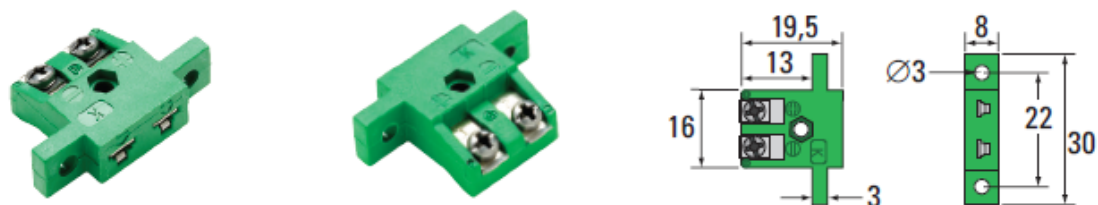
Abbildung zeigt Typ K, IEC (F27K-I), Ausschnitt: 8,5mm x 16,5mm
